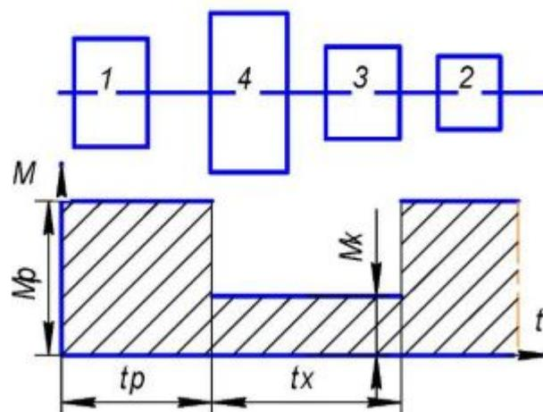
Задача 2. Определить величину  $I_M$  момента инерции маховика, если он должен быть установлен на валу рабочей машины, как это бывает на практике для условий задачи №1. Механическая характеристика двигателя
