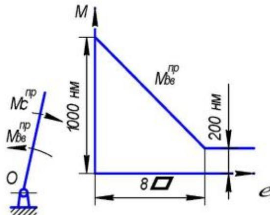
Задача 8. Силы и массы машинного агрегата приведены к главному валу. Приведенный момент движущихся сил меняется в соответствии с графиком  $M_c^{пр} = 1600$  нм и подключается в конце третьего оборота.  $Y_{пр} = 6,28$  кгм<sup>2</sup>.
