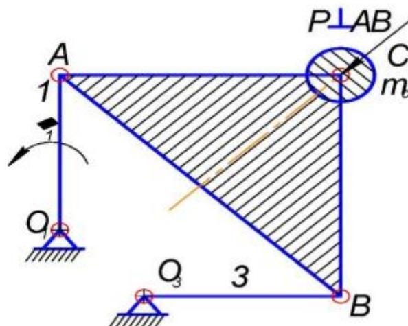
Задача 3. Определить приведенный к валу  $O_1$ , звена  $O_1A$  момент инерции  $I_{mp}$  массы шатуна 2, если его масса  $m_2 = 1$  кг,  $I_{C_2} = 0,4$  кгм<sup>2</sup>,  $AC = \frac{1}{2}AB$ ,  $AO = 0,1$  м,  $AB = 2$  м,  $BO_3 = 0,2$  м. Рассмотреть случаи, когда звенья  $AO_1$  и  $AB$  образуют одну прямую линию  $OAB$ .
