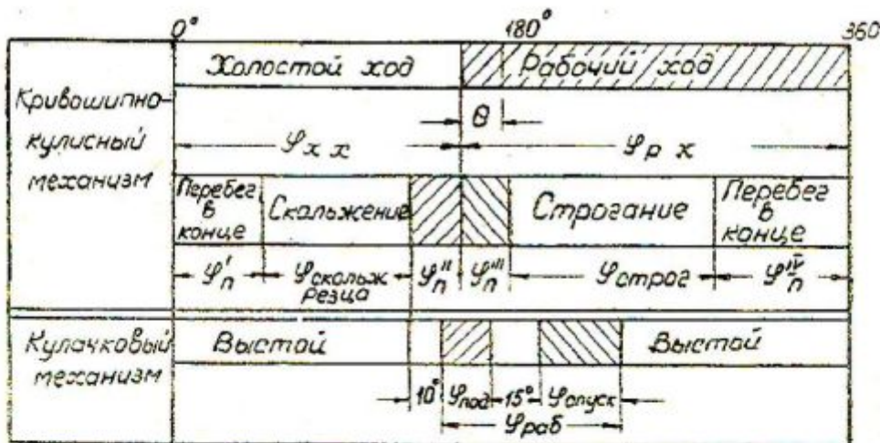
Рис. 2.10. Циклограмма работы механизмов строгального станка
