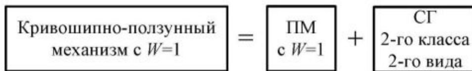
Рис. 1.2. Состав структуры кривошипно-ползунного механизма
