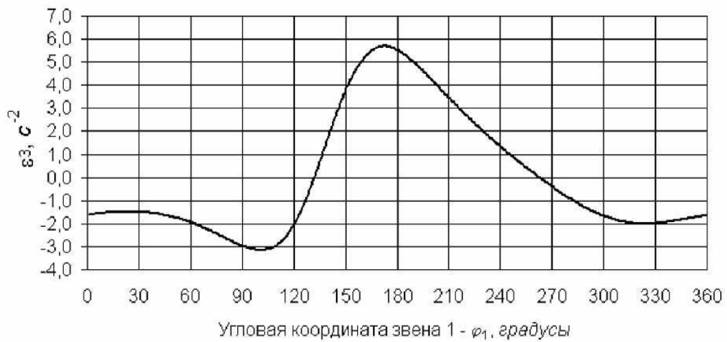
Рис. 11.18. Законы движения звеньев механизма, полученные по результатам кинематического расчета манипулятора
