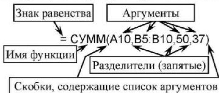
Рис. 1.14. Пример структуры функции СУММ, суммирующей значения в диапазоне ячеек
