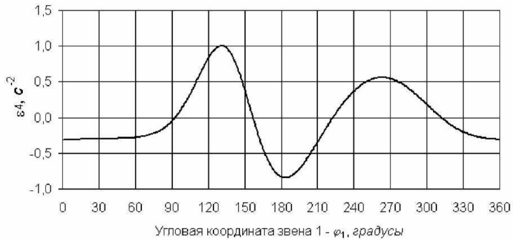
Рис. 11.19. Законы движения звеньев механизма, полученные по результатам кинематического расчета манипулятора
