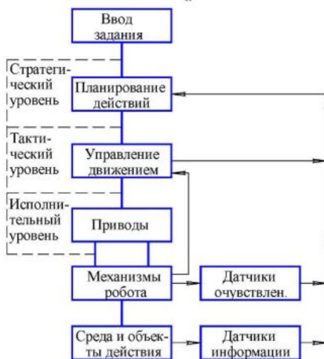
Рис. 8. 3. Общий вид адаптивного промышленного робота ( а ) и его структура ( б )
