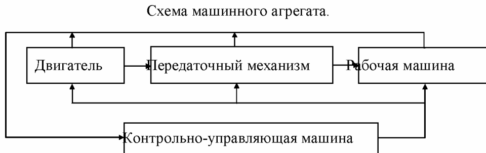
Рис.1.9 Механизм и его элементы.
