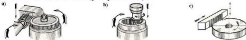
Рисунок 75 – Метод обкатки: а – червячной фрезой, б – долбяком; с – инструментальной рейкой
