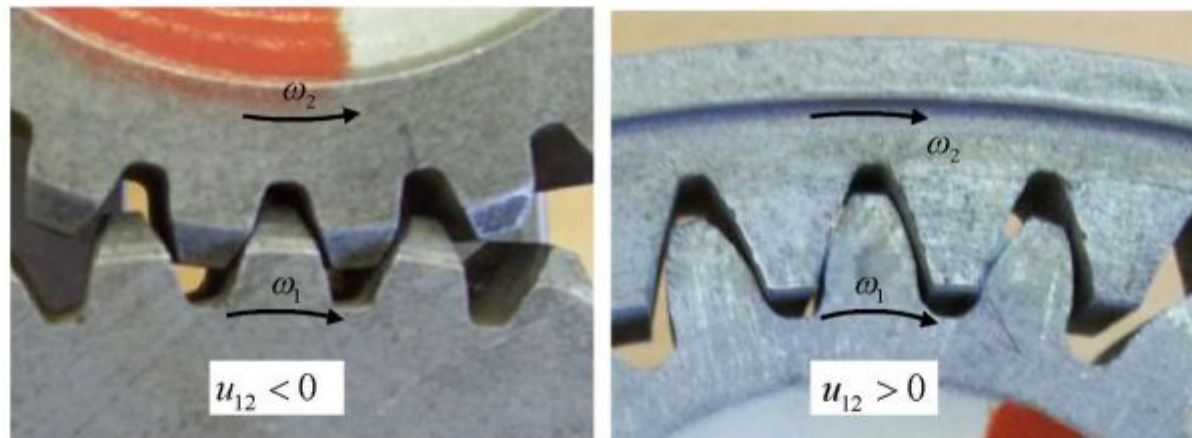
Рис.2. Виды зубчатых зацеплений: внешнее (слева) и внутреннее
