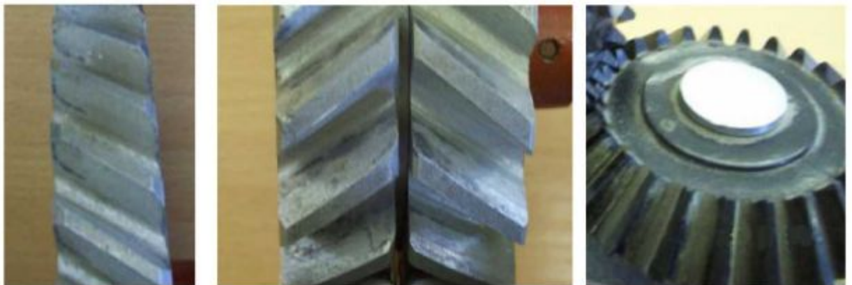
Рис.5. Виды зубчатых колес: цилиндрическое косозубое (слева), шевронное (в центре), коническое прямозубое
